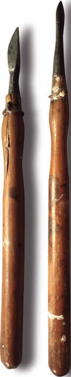
Buriles utilizados en la sección de matricería para perfeccionar los relieves en los moldes de reproducción.
